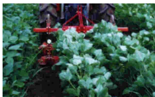
ディスク三畦リッジャー TDR-320型による大豆の中耕培土作業
